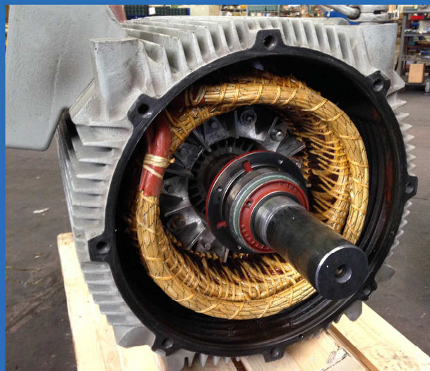
Avvolgimento motore Kw 450 poli 4
